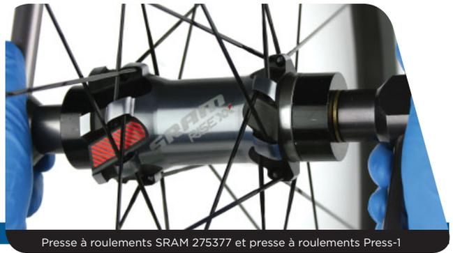
Presse à roulements SRAM 275377 et presse à roulements Press-1
