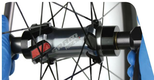
Presse à roulement SRAM 275377 et presse à roulement Press-1
