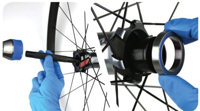
**5** À l'aide d'un chiffon, nettoyez l'emplacement des roulements.
