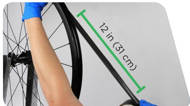
剪切垫带。用手指或胎撬抵住垫带的边缘，使之紧贴轮圈。这将有助于防止密封剂漏到垫带下面。
