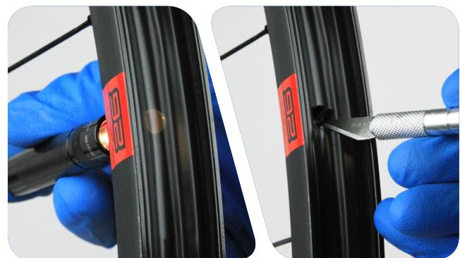
从气门杆上取下螺母和 O 型密封圈。将气门杆穿过轮圈。
