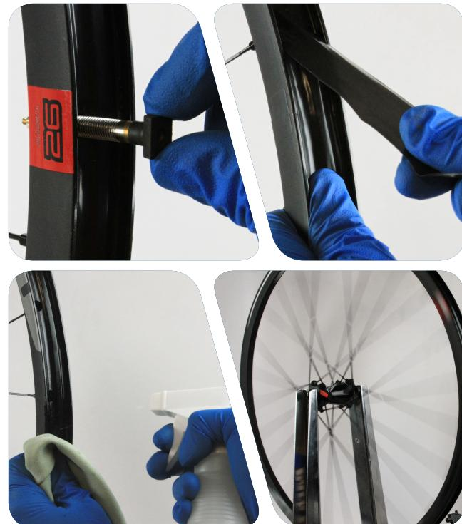
将垫带的初始部分置于与气门杆孔呈 180 度的两个辐条孔之间。
