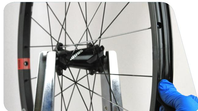
向着与您自己相反的方向旋转车轮，同时以大约 5-8 cm 的幅度快速左右“摇晃”垫带，向垫带施加张力。这样，垫带就会嵌入槽沟中，并保持在轮圈中央位置。
