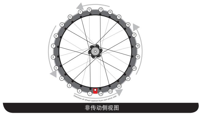
用辐条扳手或内接头扳手旋转每根**传动侧辐条**，每次旋转 1/2 圈，直至**传动侧辐条张力**约为[车轮型号表](#)指定的最终张力值的 30-40%。
