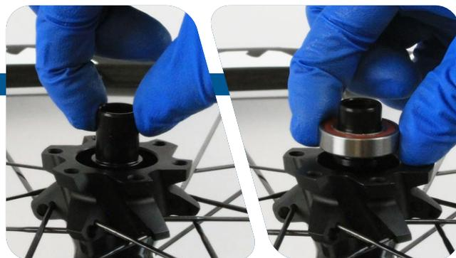
**28** 将短安装气缸装到轮轴和轴承上。用柔面橡皮锤敲击短安装气缸，直至轴承紧紧卡入轴承凹槽。
