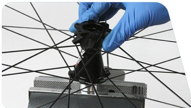
**19** 将另一个短安装气缸装到轮轴上，插入轮毂。用柔面橡皮锤敲击短安装气缸，直至轴承紧紧卡入轴承凹槽。
