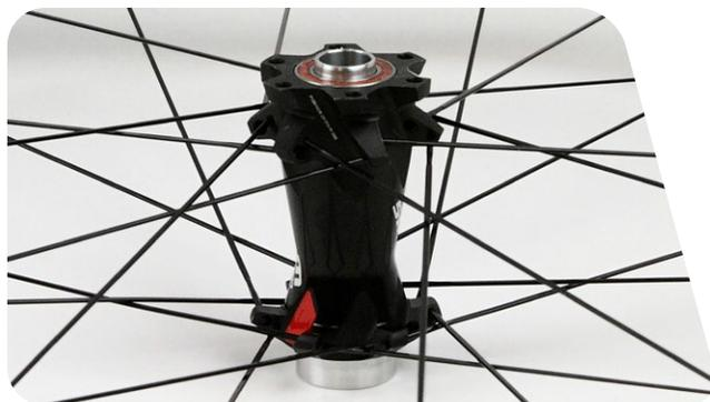
**14** 将另一个大直径轮毂工具装到轮轴上，插入轮毂。用柔面橡皮锤敲击工具，直至轴承紧紧卡入轴承凹槽。
