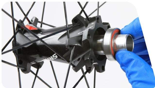
**12** 将一个大直径轮毂工具装入轮毂的无刹车一侧。这将有助于保持轮轴对齐。
