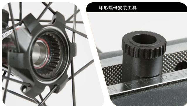
**8** 将轮毂的塔基侧装到环形螺母安装工具上。用力按下车轮并旋转，以确保工具锯齿与环形螺母啮合。
