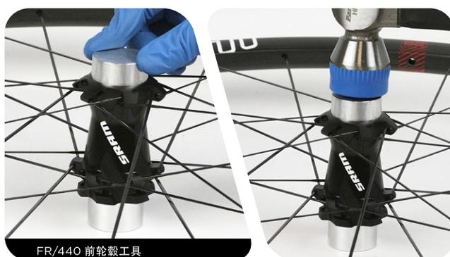
**15** 从轮轴上卸下上一个 LFR/440 前轮毂工具。将新的轴承装到轮轴上，红色密封圈背向轮毂。
