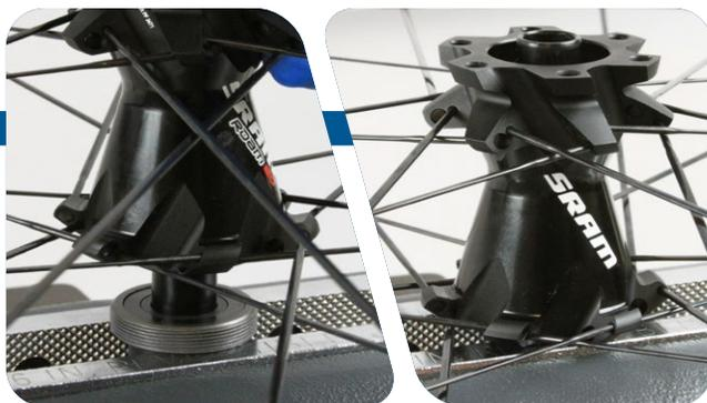
**23** 将一个短安装气缸装入老虎钳。将轮轴的盘式刹车一头装入短安装气缸。
