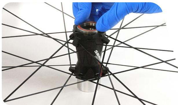
**10** 将小梯段式工具插入轮轴和轴承。将其他 FR/440 前轮毂工具装到小梯段式工具上，抵住轴承表面。
