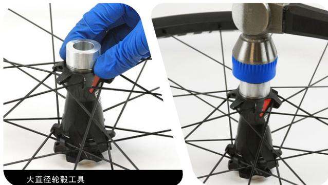
**17** 在轮毂中推拉轮轴，检查是否晃动。如果检测到晃动，则重复第 12-16 步。
