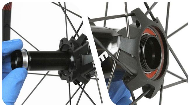
**8** 将小梯段式工具插入轮轴。用柔面橡皮锤敲击轮轴，将轴承从轮毂中取下。
