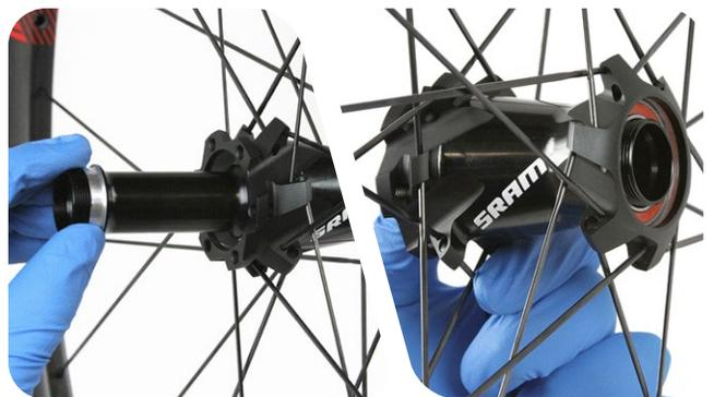
**8** 将其中一个 FR/440 前轮毂工具插入轮毂，抵住已安装轴承的表面。
