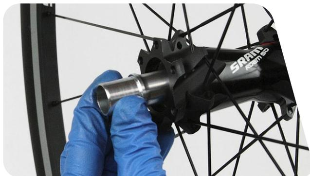
**6** 将长梯段式工具装入轮轴。用柔面橡皮锤敲击轮轴，将轴承从轮毂中取下。
