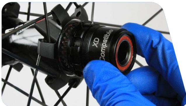
**38** 在传动器轴承上涂一层薄薄的润滑脂。用抹布或纸巾擦掉轮轴端头残留的润滑脂。
