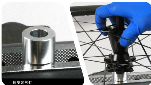
**24** 将刹车碟密封圈放在密封圈安装工具上，橡皮密封圈朝向工具。将工具放在轮轴上，刹车碟密封圈朝向轮毂。
