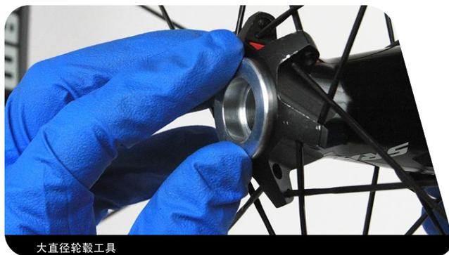
**13** 将大直径轮毂工具和车轮放到工作台上，盘式刹车一侧朝上。
