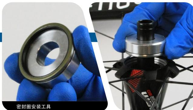
**25** 将长安装工具放在轮轴上。用柔面橡皮锤敲击长安装工具，直至刹车碟密封圈卡入轮毂罩。
