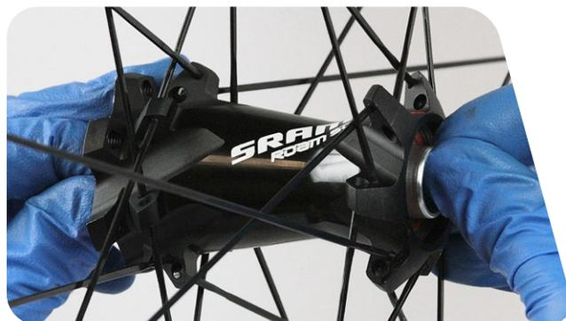
**18** 在每个轴承表面上涂薄薄的一层润滑脂。用抹布或纸巾擦掉轮轴端头残留的润滑脂。
