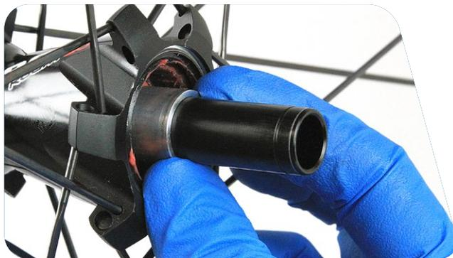
**33** 将弹簧装到轮轴上，置于垫片上方。弹簧的宽口朝向轮毂。
