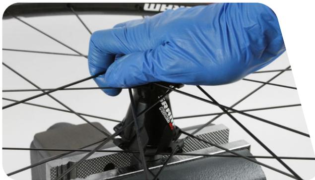
**9** 用力按下车轮并逆时针方向旋转，从轮毂上卸下环形螺母。刹车碟的密封圈也将卸下，可能掉到环形螺母工具和老虎钳上。从工具上取下环形螺母。清洁环形螺母并检查是否损坏。如果损坏了，则更换环形螺母。
