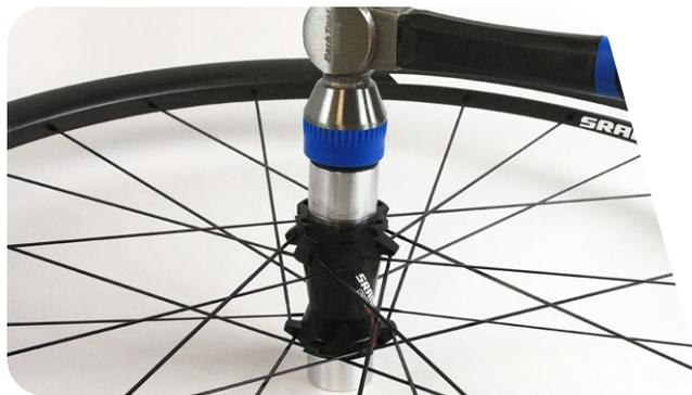
**12** 在轮毂中推拉轮轴，检查是否晃动。如果检测到晃动，则重复第 8-11 步。
