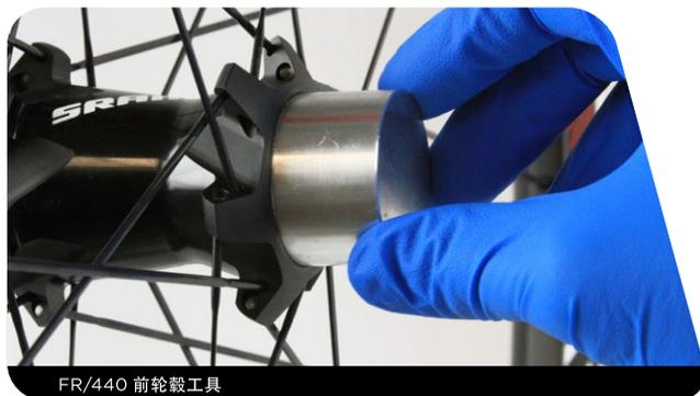
**9** 将 FR/440 前轮毂工具和车轮放在工作台上。将其他轴承装到轮轴上，红色密封圈背向轮毂。
