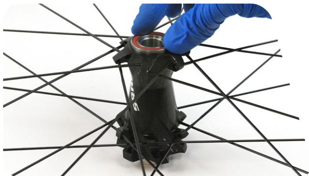
**16** 将另一个大直径轮毂工具装到轮轴上，插入轮毂。用柔面橡皮锤敲击工具，直至轴承紧紧卡入轴承凹槽。定期检查轮毂中轴承对齐情况。
