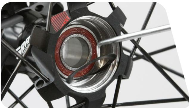
**11** 将轮轴短头穿过轮毂的盘式刹车一侧，插入塔基侧轴承。
