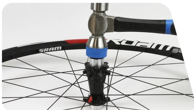
**15** 翻转车轮，使大直径轮毂工具和已安装的轴承在工作台上。将新的轴承装到轮轴上。
