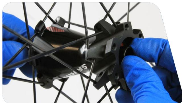
**30** 在非塔基侧轴承表面涂薄薄的一层润滑脂。用抹布或纸巾擦掉轮轴端头残留的润滑脂。
