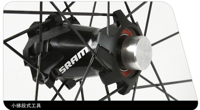
**3** 用柔面橡皮锤将轮轴从轮毂中敲出。
