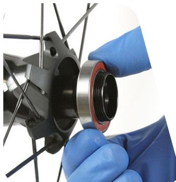
**9** 从轮轴上卸下轴承并丢弃。将新的轴承装到轮轴上，红色密封圈背向轮轴。
