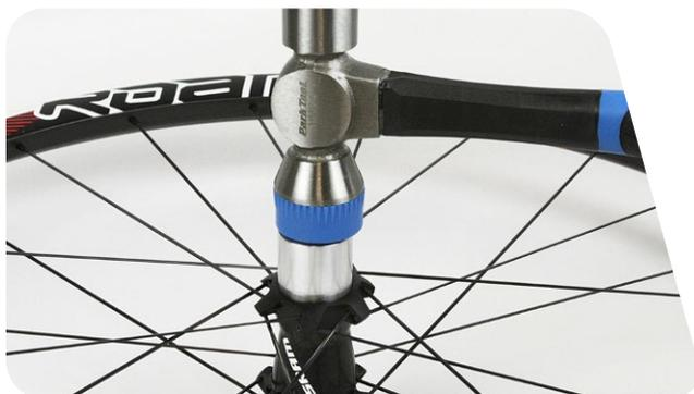
**18** 在轮毂中推拉轮轴，检查是否晃动。如果检测到晃动，则重复第 16 和 17 步。
