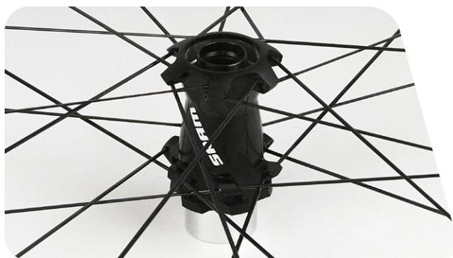
14 将另一个 FR/440 前轮毂工具装到轮轴上，装入轮毂。用柔面橡皮锤敲击工具，直至轴承紧紧卡入轴承凹槽。
