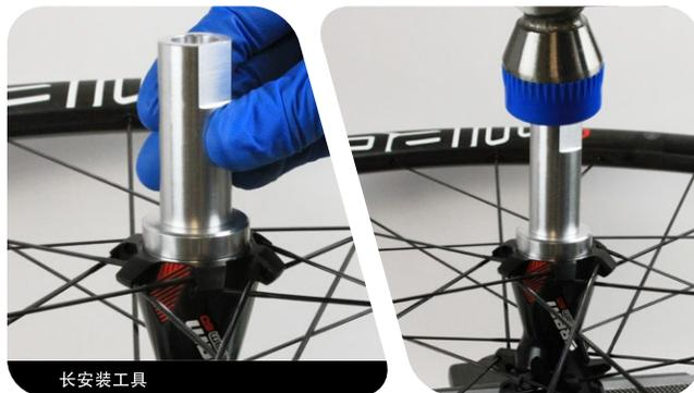
**26** 将环形螺母安装工具装入老虎钳。将轮轴塔基侧装入环形螺母安装工具，并用力往下压，确保工具锯齿与环形螺母的锯齿啮合。
