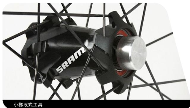
**3** 用柔面橡皮锤将轮轴从轮毂中敲出。
