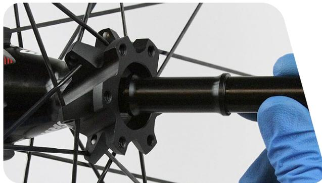
**12** 用柔面橡皮锤敲击轮轴，将轴承从轮毂中取下。
