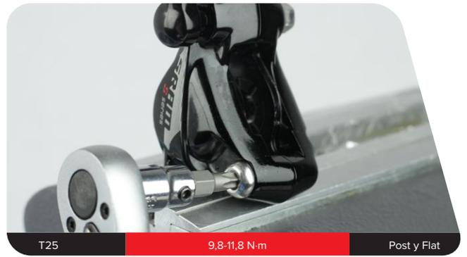
**6** **Solo para pinzas de anclaje paralelo a la rueda (Post mount):** Retire la junta tórica del tornillo de banjo. Aplique grasa a la nueva junta tórica e instálela sobre el tornillo. Instale el tornillo en la pinza de freno.
