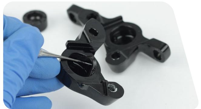
**8** Rocíe con alcohol isopropílico el interior de cada uno de los cilindros donde va el pistón, así como el interior y el exterior de la pinza de freno, y límpielos con un trapo.
