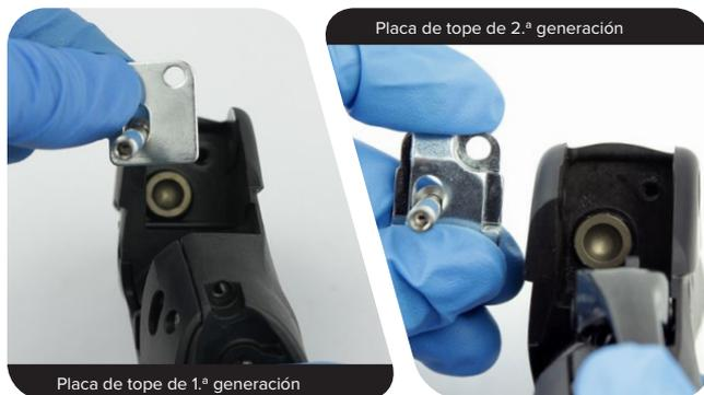
**4 Placa de tope de 1.<sup>a</sup> generación:** Con una llave Allen de 2,5 mm, presione hacia abajo la leva de ajuste de alcance de modo que empuje contra la cabeza del pistón del cilindro principal, y utilice un punzón para asentar en la cubierta protectora la placa de tope del pistón que va debajo del manillar.
