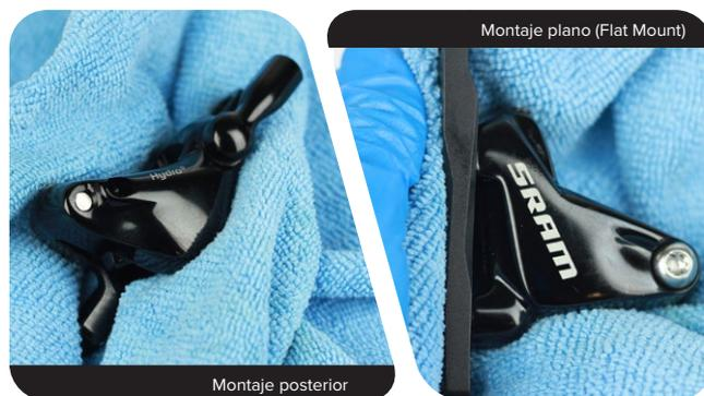
**9** Inserte el bloque de purgado en la pinza de freno. Coloque el tornillo de retención de las pastillas.
