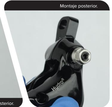
**Solo para pinzas de anclaje plano (Flat mount):** Retire las juntas tóricas del tornillo de banjo. Aplique grasa a las nuevas juntas tóricas e instálelas sobre el tornillo de banjo de modo que quede una a cada lado del racor de tornillo de banjo.
