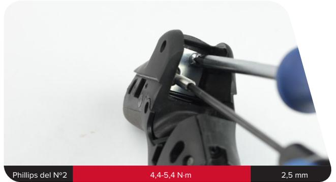
**Placa de tope de 2.<sup>a</sup> generación:** Apriete el tornillo autorroscante en la placa de tope.
