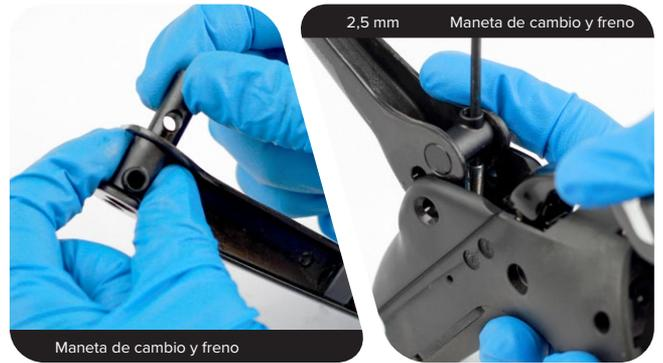
**Maneta de freno:** Instale el tambor pivote interior dentro de la maneta, de modo que el orificio del tambor quede alineado con la leva de ajuste de alcance situada dentro de la funda protectora.
