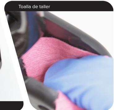
**11** Aplique una suave presión a la jeringa de purgado hasta que el pistón del cilindro sobre salga del orificio lo suficiente como para agarrarlo con los dedos.
