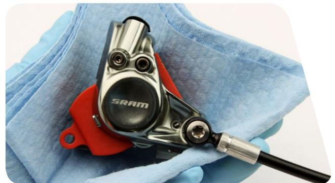
Führen Sie eine Sichtprüfung durch. Wenn ein O-Ring über die Außenkanten der Bremsleitungsaufnahme und der Achsschraube hervorsteht, entfernen und erneuern Sie ihn. Wiederholen Sie danach das Einbauverfahren.
