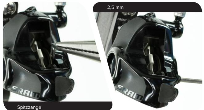
**3** Entfernen Sie die Bremsbeläge vom Bremssattel.
