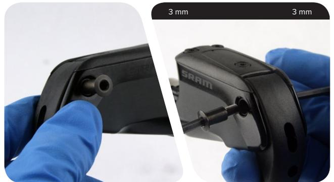
**3** Halten Sie die Gelenkstiftmutter mit einem 3-mm-Inbusschlüssel in Position und ziehen Sie die Gelenkstiftschraube fest.
