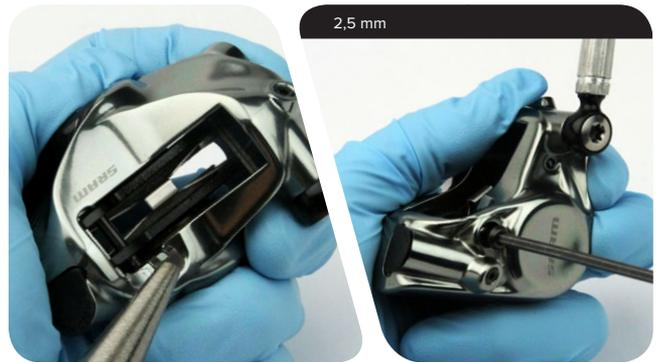
**3** Entfernen Sie die Bremsbeläge vom Bremssattel.
