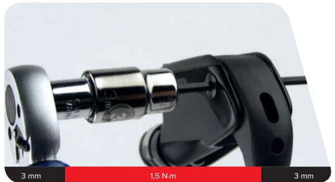
**4** Ziehen Sie den Bremshebel, bis die Spitze der Druckstange auf dem Geberkolben sitzt.
