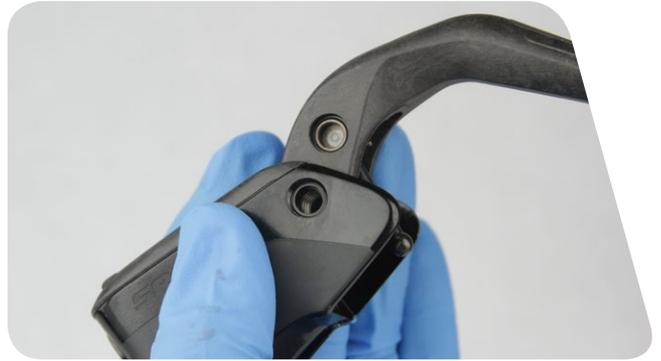
**2** Setzen Sie die Gelenkstiftmutter an einer Seite des Hebelkörpers ein. Halten Sie die Gelenkstiftmutter mit einem Schlüssel in Position und montieren Sie die Gelenkstiftschraube auf der anderen Seite.
