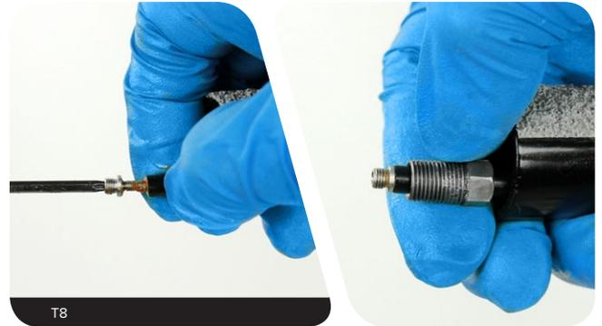
**7** Schrauben Sie einen neuen Klemmring gegen den Uhrzeigersinn auf den Leitungsnippel, bis er bündig mit dem Leitungsnippel abschließt oder etwas darunter sitzt.
