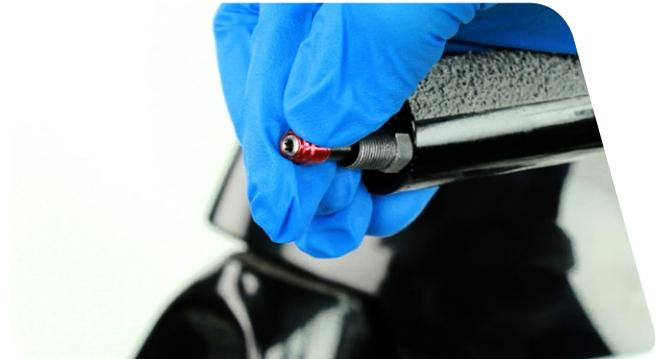
**8** Tragen Sie eine dünne Schicht Schmierfett auf den Klemmring und die Überwurfmutter auf.
