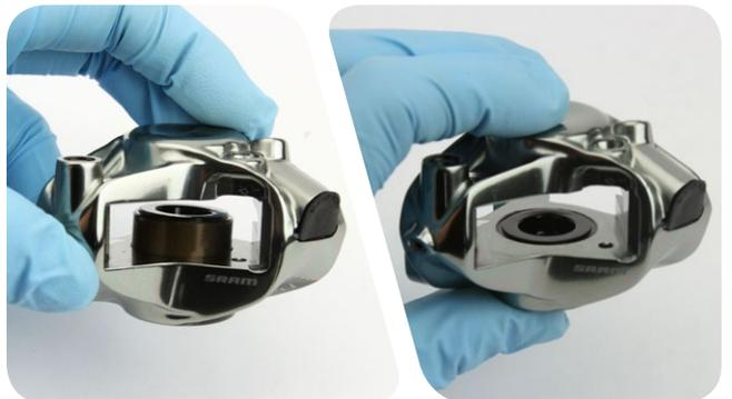
**Tipp:** Wenn ein Kolben sich schwer in eine Kolbenbohrung einführen lässt, legen Sie den Bremssattel auf eine flache Oberfläche. Schieben Sie einen Schraubenschlüssel durch den Bremssattel und drücken Sie dann den Kolben vorsichtig und gleichmäßig in die Bohrung.
