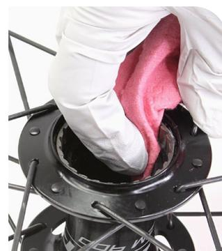
**9** Limpie el anillo de trinquete y las partes internas del buje con alcohol isopropílico, una toalla de taller y bastoncillos de algodón. No extraiga el anillo de trinquete.
