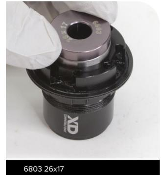
**7** Introduzca la varilla roscada por la cara interior del núcleo. Inserte una segunda herramienta 6803 26x17 en la varilla roscada.
