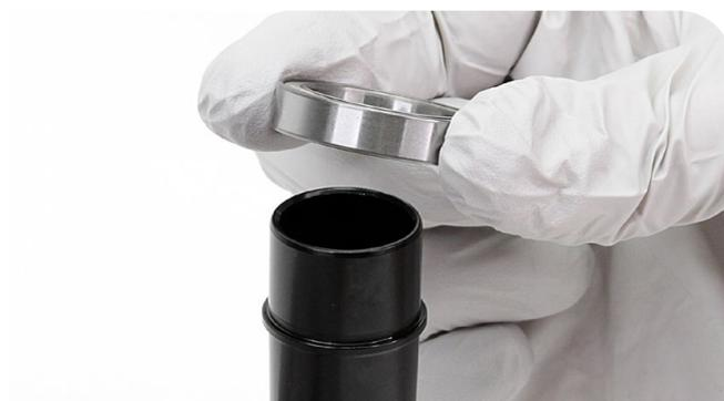
**4** Introduzca el eje en el lado motriz del buje y en el rodamiento del lado no motriz.
