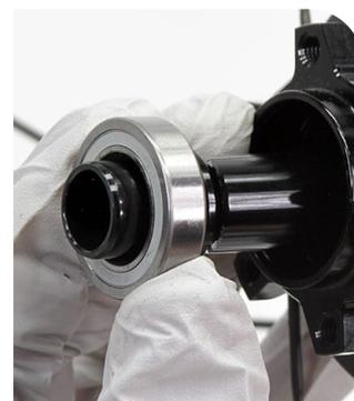
**7** Limpie el eje con alcohol isopropílico y una toalla de taller.
