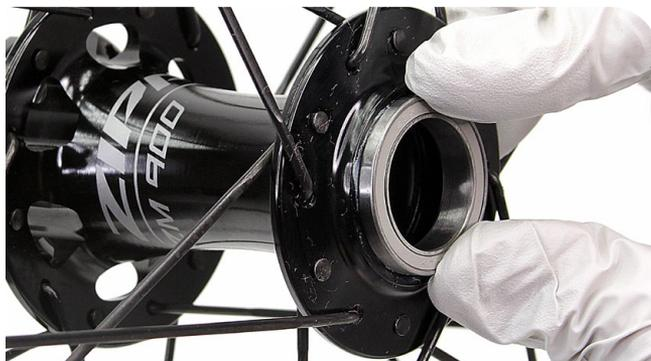
**5** Deslice una herramienta de prensa de rodamientos Zipp 23x32x7 en la varilla roscada de la herramienta.
