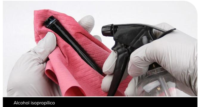
**6** Limpie los orificios del rodamiento con alcohol isopropílico y una toalla de taller.
