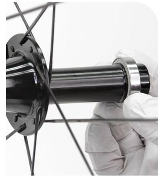
**5** Pulverice alcohol isopropílico sobre el eje y límpielo con una toalla de taller.
