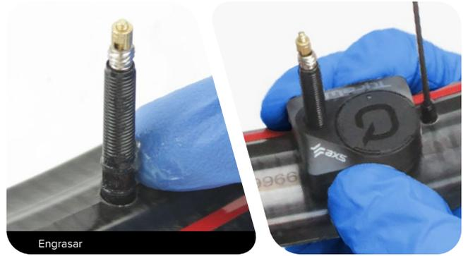
**4** Instale una junta tórica en el vástago de la válvula.
