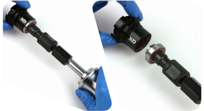
**5** Retire el tubo espaciador del ID (diámetro interior) y el tubo espaciador del OD (diámetro exterior).
