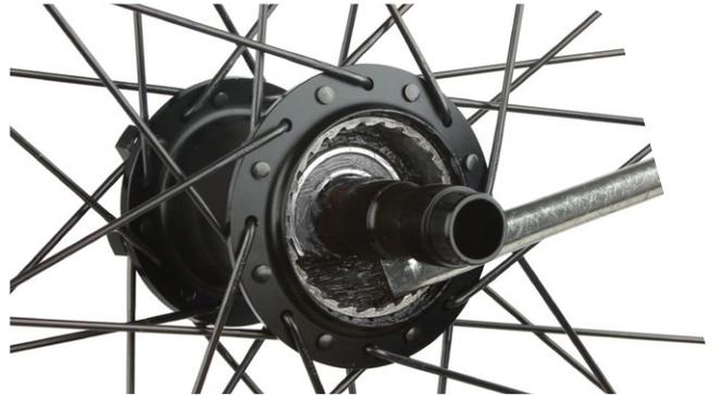
**8** Instale el tubo espaciador en el eje.
