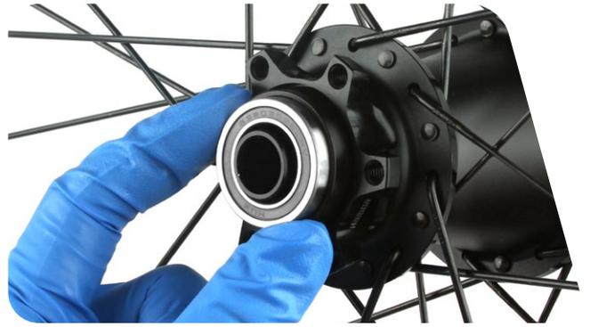
**6** Deslice una herramienta de prensa de casquillos SRAM® 6903 en la varilla roscada de la herramienta de prensa de casquillos. Introduzca la varilla roscada de la prensa de casquillos a través del lado motriz de la carcasa del buje. Deslice la herramienta de prensa de casquillos SRAM 63803 en la varilla roscada.
