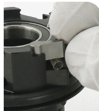
**9** Utilice un destornillador de punta plana pequeño para comprimir el muelle y permitir que la uña caiga en la ranura. A continuación, ajuste el muelle para que quede perpendicular a la parte posterior de la uña.
