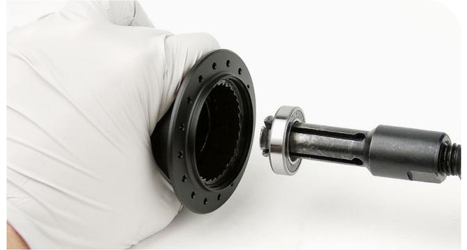
**9** Introduzca el accesorio ranurado de 17 mm del extractor de rodamientos a través del rodamiento por el lado no motriz. Alinee el accesorio ranurado con la parte inferior del rodamiento y expándalo dentro del rodamiento.
