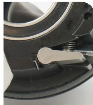
**10** Oriente el extremo de la arandela de presión dentro del orificio del núcleo y presione la arandela contra el canal del núcleo hasta que quede completamente asentada.
