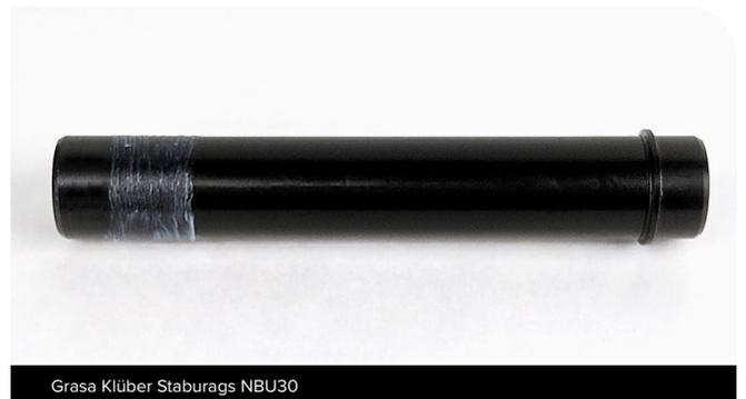
**6** Introduzca el extremo del lado no motriz del eje en el lado motriz del buje, a través del rodamiento del lado motriz, del buje y del rodamiento del lado no motriz. Inserte el eje en el rodamiento del buje presionándolo con el pulgar hasta que el escalón del rodamiento del eje quede a ras con el rodamiento.
