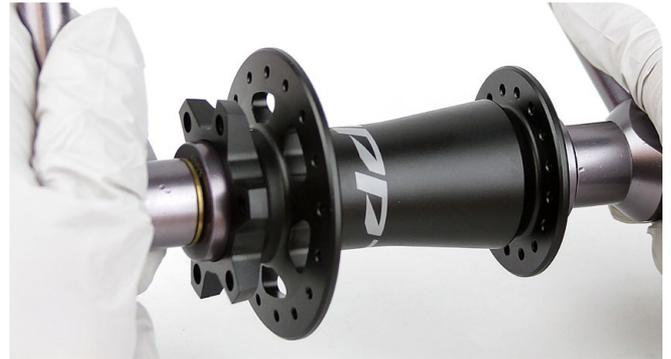
**5** Aplique grasa a la superficie de rodadura del rodamiento del eje por el lado no motriz.
