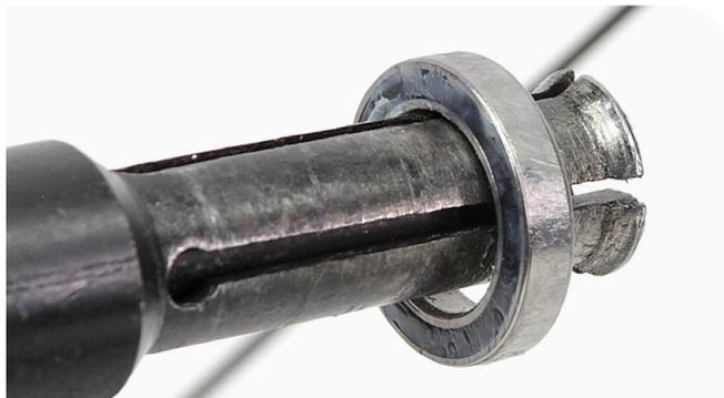
**8** Introduzca el accesorio ranurado de 17 mm del extractor de rodamientos a través del rodamiento por el lado motriz. Alinee el accesorio ranurado con la parte inferior del rodamiento y expándalo dentro del rodamiento.
