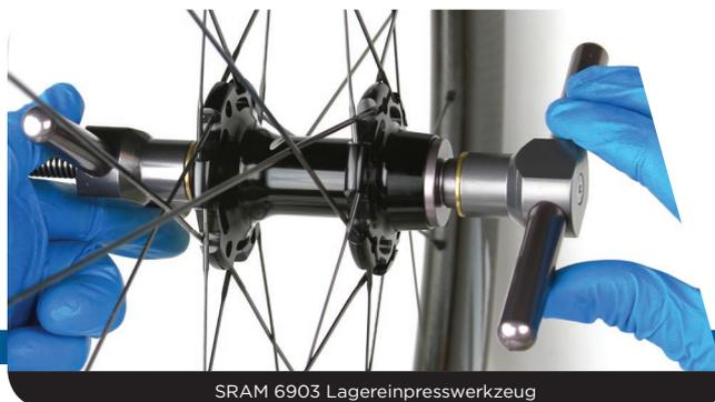
SRAM 6903 Lagereinpresswerkzeug
