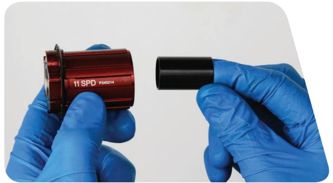
**8** Führen Sie den geschlitzten 17-mm-Aufsatz für den Gleithammer-Lagerabzieher durch das innere Lager. Richten Sie den geschlitzten Aufsatz am unteren Rand des Lagers aus und drehen Sie den geschlitzten Aufsatz fest, um den Abzieher im Lager zu erweitern.
