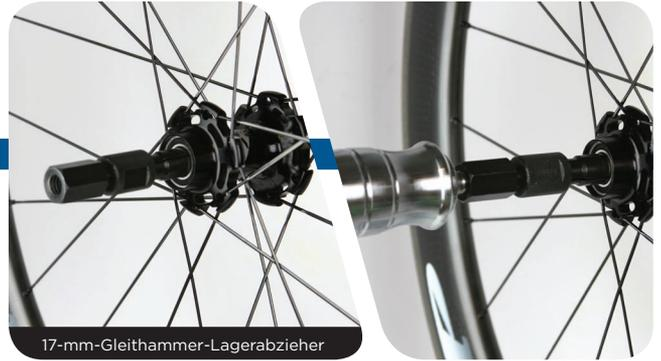
Schrauben Sie den Stab des Lagerabziehers in den Aufsatz. Nehmen Sie den Gleithammer in die Hand und ziehen Sie ihn kräftig vom geschlitzten Aufsatz zurück, um das Lager aus dem Nabenkörper zu entfernen.
