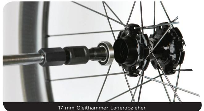
**7** Entfernen Sie das Lager-Distanzrohr.
