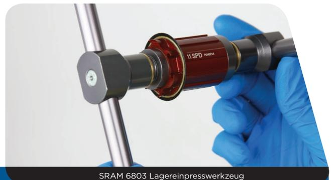
SRAM 6803 Lagereinpresswerkzeug
