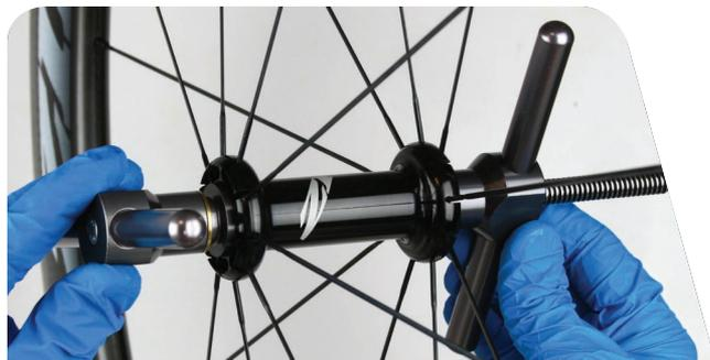
SRAM 6803 Lagereinpresswerkzeug
