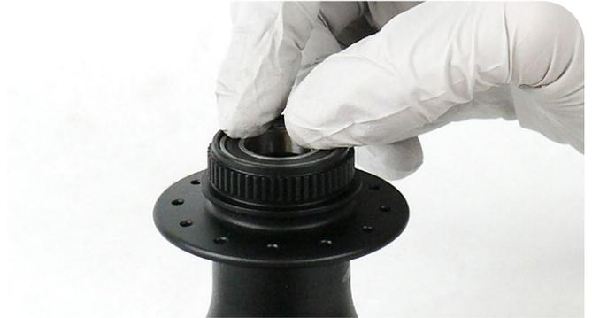
**2** Inserte una herramienta adaptadora 6903 30x17 en el orificio del rodamiento del lado motriz.
