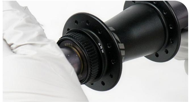
**5** Aplique grasa a la superficie de rodadura del rodamiento del eje por el lado no motriz.
