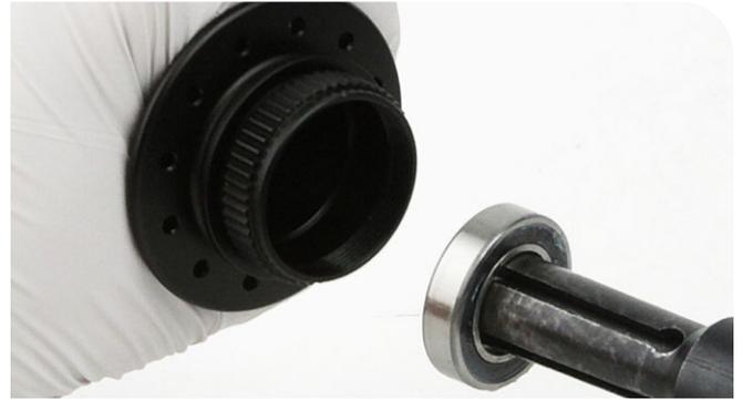
**7** Limpie carcasa del buje con alcohol isopropílico y una toalla de taller.
