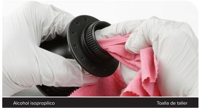
**10** Limpie el anillo de trinquete y las partes internas del buje con alcohol isopropílico, una toalla de taller y bastoncillos de algodón. No extraiga el anillo de trinquete.
