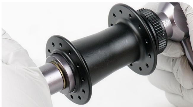
**3 ZR1:** Instale un nuevo rodamiento del buje Zipp 6903/61903 en el lado no motriz del buje, con la junta negra orientada hacia afuera.
