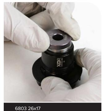
**5** Introduzca la varilla roscada por la cara exterior del núcleo. Inserte una segunda herramienta 6803 de 26x17 en la varilla roscada.
