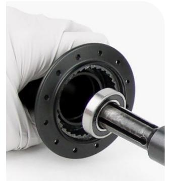
**8** Introduzca el accesorio ranurado de 17 mm del extractor de rodamientos a través del rodamiento por el lado no motriz. Alinee el accesorio ranurado con la parte inferior del rodamiento y expándalo dentro del rodamiento.
