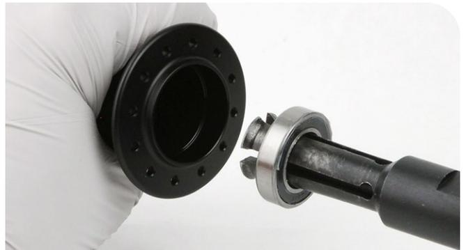
**6** Introduzca el accesorio ranurado de 17 mm del extractor de rodamientos a través del rodamiento por el lado no motriz. Alinee el accesorio ranurado con la parte inferior del rodamiento y expándalo dentro del rodamiento.
