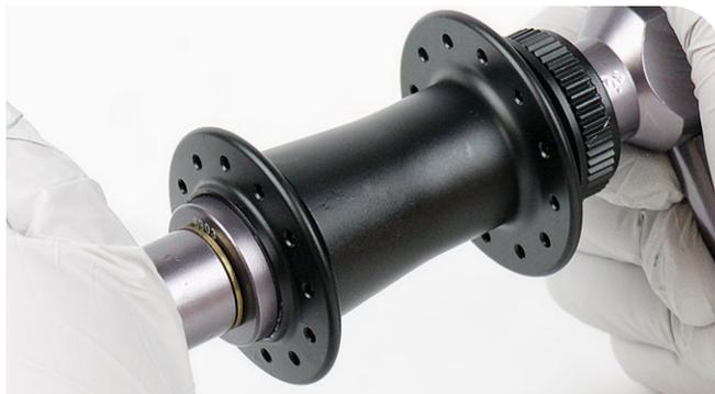
**3** **ZR1:** installez un roulement de moyeu Zipp 6903/61903 neuf dans le moyeu du côté opposé à la chaîne en orientant le joint de couleur noire vers l'extérieur.
