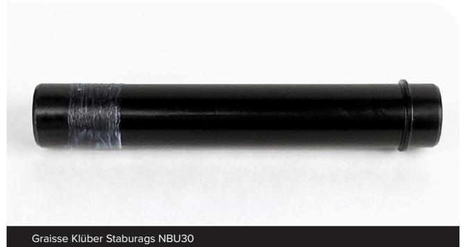
**6** Insérez l'axe du côté opposé à la chaîne dans le moyeu du côté de la chaîne, en le faisant passer à travers le roulement du côté de la chaîne, à travers le moyeu et à travers le roulement du côté opposé à la chaîne. Avec le pouce, enfoncez l'axe dans le roulement du moyeu jusqu'à ce que le roulement affleure avec l'épaulement de l'axe destiné au roulement.
