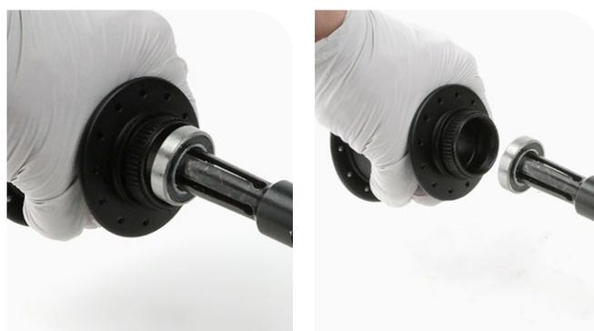
**9** À l'aide d'un chiffon, nettoyez l'emplacement des roulements.
