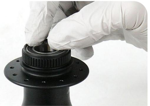
**2** Installez un outil 6903 30x17 dans l'emplacement du roulement du côté de la chaîne.
