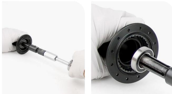
**8** Insérez l'extracteur fendu de 17 mm de l'arrache-roulement dans le roulement du côté opposé à la chaîne. Alignez l'extracteur fendu avec la base du roulement, puis serrez-le à l'intérieur du roulement.
