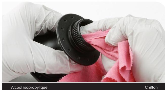
**10** Nettoyez le mécanisme à rochet et les parties internes du moyeu avec de l'alcool isopropylique, un chiffon et des cotons-tiges. Ne retirez pas le mécanisme à rochet.
