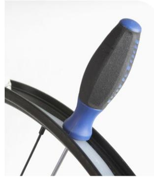
**6** Installez la bande anti-crevaisson sur la jante en la centrant parfaitement dans la gorge de la jante : tous les rayons et leurs écrous sont ainsi recouverts mais le trou de la valve reste intégralement visible.
