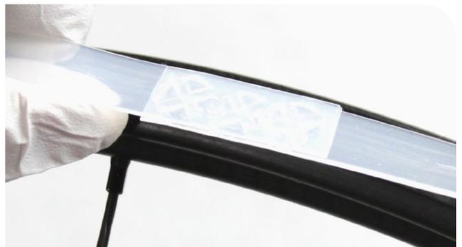
**5** Alignez le trou percé pour la valve dans la bande anti-crevaisson avec l'œillet en caoutchouc du trou de la valve situé dans la jante.
