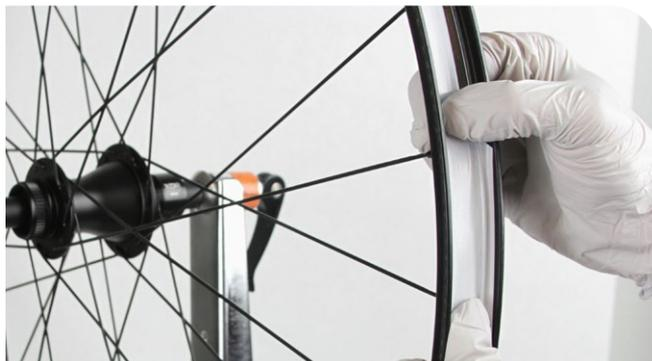
**8** Appliquez une certaine tension sur le fond de jante tout en faisant tourner la roue dans le sens opposé jusqu'à ce qu'il y ait 2 couches complètes de fond de jante sur la jante. Vérifiez qu'il n'y a pas de plis et que le fond de jante est parfaitement centré sur la jante.
