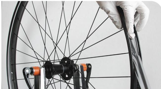
**7** Appliquez une certaine tension sur le fond de jante tout en faisant tourner la roue dans le sens opposé jusqu'à ce qu'il y ait 2 couches complètes de fond de jante sur la jante. Vérifiez qu'il n'y a pas de plis et que le fond de jante est parfaitement centré sur la jante.
