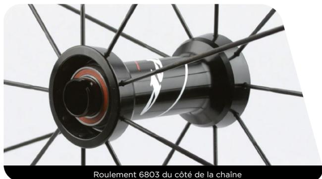
Roulement 6803 du côté de la chaîne
