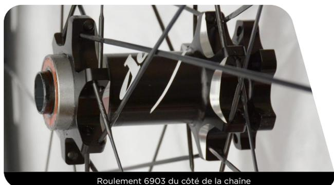
Roulement 6903 du côté de la chaîne
