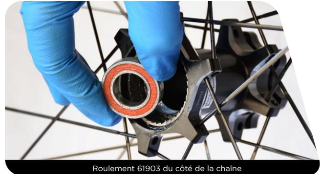
Roulement 61903 du côté de la chaîne
