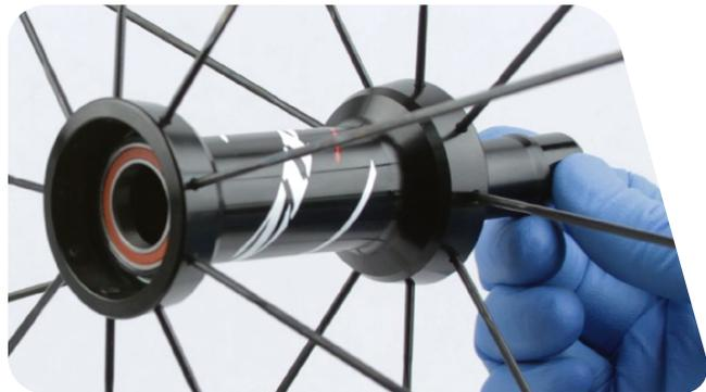
**4** Installez un roulement neuf sur l'axe dans son emplacement du moyeu avant du côté de la chaîne avec le joint de couleur **orange** tourné vers l'extérieur.
