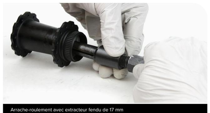
Arrache-roulement avec extracteur fendu de 17 mm
