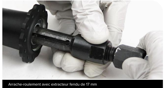
Arrache-roulement avec extracteur fendu de 17 mm
