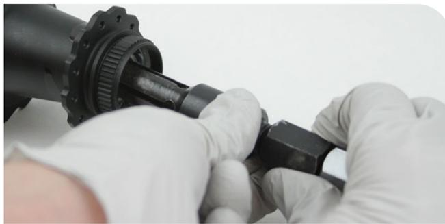
Arrache-roulement avec extracteur fendu de 17 mm
