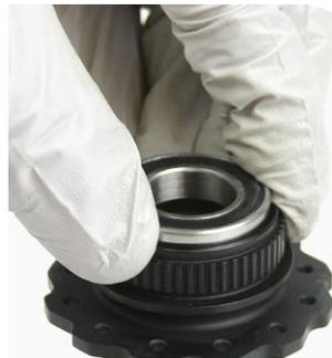
Roulement de moyeu 6903/61903
