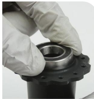
Roulement de moyeu 6903/61903
