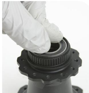
Roulement de moyeu 6903/61903
