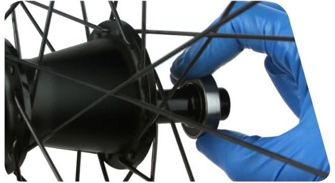
**6** Nettoyez l'anneau du rochet et les parties internes du moyeu avec de l'alcool isopropylique, un chiffon et des cotons-tiges. Ne retirez pas l'anneau du rochet.
