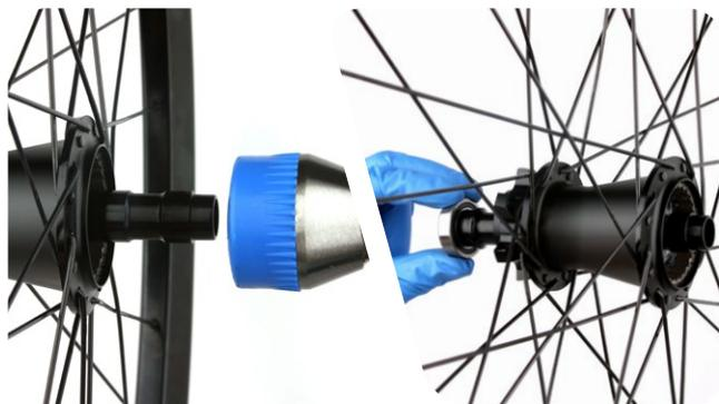
**5** Insérez le côté opposé à la chaîne de l'axe dans le côté opposé à la chaîne du moyeu.
