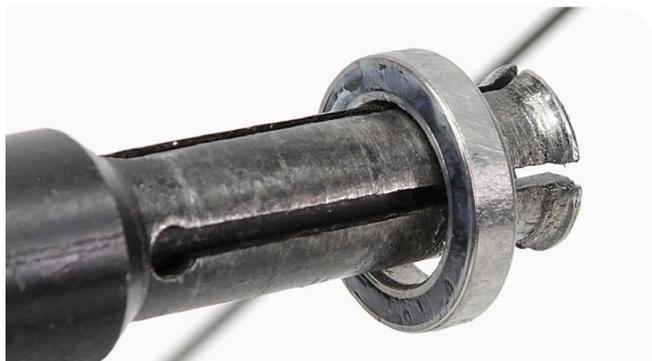
**8** Insérez l'extracteur fendu de 17 mm de l'arrache-roulement à travers le roulement du côté de la chaîne. Alignez l'extracteur fendu avec la base du roulement puis serrez-le à l'intérieur du roulement.
