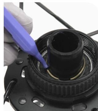
**12** Appliquez de la graisse aux endroits indiqués ci-dessous sur les deux extrémités de l'axe, du côté de la chaîne et du côté opposé à la chaîne :
