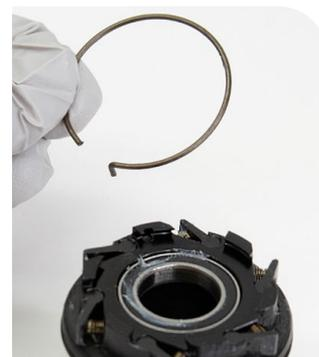
**3** À l'aide de vos doigts, d'une pointe ou d'une pince à bec fin, retirez les cliquets et les ressorts hélicoïdaux hors du corps de cassette.
