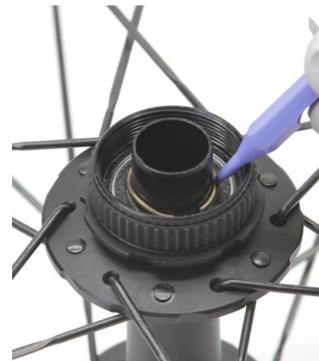
**10** Appliquez de la graisse aux endroits indiqués ci-dessous sur les deux extrémités de l'axe, du côté de la chaîne et du côté opposé à la chaîne :
