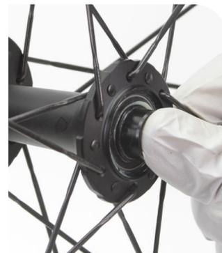
**8** Installez le ressort ondulé sur l'axe du côté opposé à la chaîne. Vous pouvez utiliser un outil pour installer le ressort ondulé contre le pourtour du roulement.
