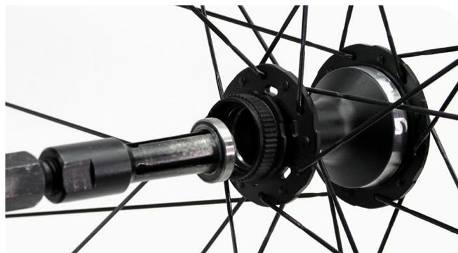
**8** Insérez extracteur fendu de 17 mm de l'arrache-roulement à travers le roulement du côté de la chaîne. Alignez l'extracteur fendu avec la base du roulement puis serrez-le à l'intérieur du roulement.
