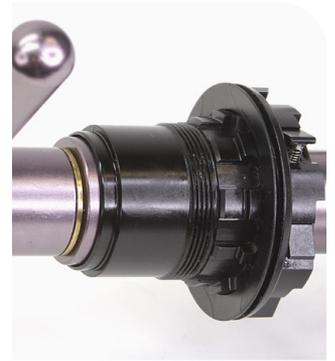
**6** Posez le corps de cassette sur une surface plane en tournant son côté interne vers le haut. Insérez un roulement Zipp 6803/61803 neuf dans le côté interne du corps de cassette en tournant le joint **noir** vers l'extérieur.
