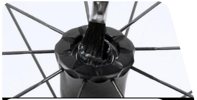
**4** Vaporisez de l'alcool isopropylique sur un chiffon puis nettoyez les coupelles. Appliquez de la graisse Zipp Cognition ou SRAM Butter sur la face interne des deux coupelles.
