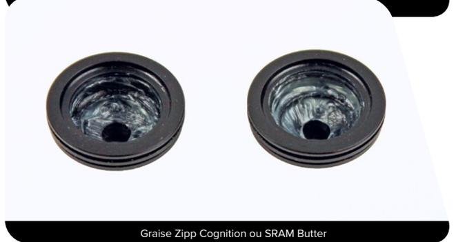
**5** Mettez les coupelles en place à la main et enfoncez-les sur l'axe jusqu'à ce qu'elles s'emboîtent parfaitement. Essuyez tout débordement de graisse sur le moyeu et les coupelles.
