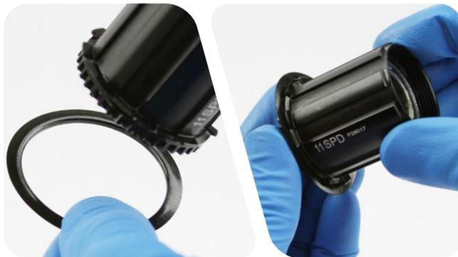
**2** Appliquez de la graisse Zipp Cognition ou SRAM Butter sur la partie externe de l'axe du côté de la chaîne. Essayez tout excès de graisse avec un chiffon.
