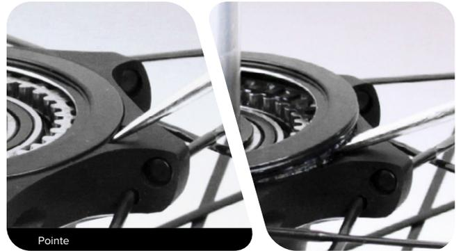
Avec les doigts, retirez le joint torique. Vaporisez de l'alcool isopropylique sur le capuchon d'étanchéité de l'embrayage ainsi que sur le joint torique puis essuyez-les avec un chiffon. Remettez le joint torique en place sur le capuchon d'étanchéité de l'embrayage.
