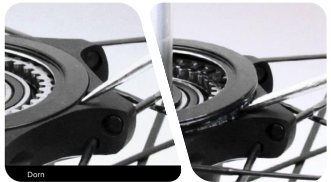
Entfernen Sie den O-Ring mit den Fingern. Sprühen Sie Isopropyl-Alkohol auf die Kupplungsdichtkappe und den O-Ring und wischen Sie die Teile mit einem Lappen ab. Bringen Sie den O-Ring wieder an der Kupplungsdichtkappe an.
