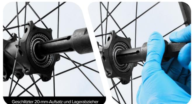
Geschlitzter 20-mm-Aufsatz und Lagerabzieher
