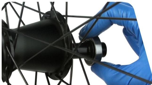
**6** Reinigen Sie den Zahnscheibenring und die Innenteile der Nabe mit Isopropyl-Alkohol, einem Werkstatttuch und Wattestäbchen. Entfernen Sie nicht den Zahnscheibenring.
