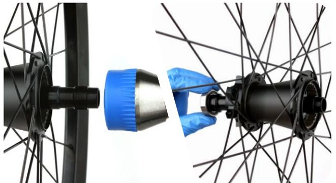
**5** Schieben Sie die Nicht-Antriebsseite der Achse durch die Nicht-Antriebsseite der Nabe.
