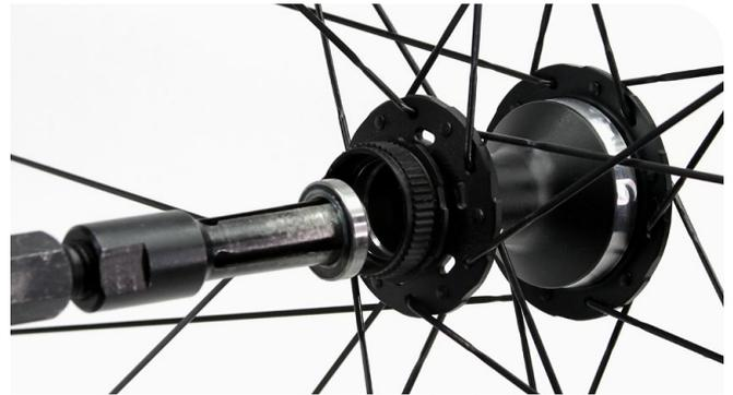
**8** Führen Sie den geschlitzten 17-mm-Aufsatz für den Lagerabzieher durch das Lager auf der Antriebsseite. Richten Sie den geschlitzten Aufsatz am unteren Rand des Lagers aus und erweitern Sie ihn im Lager.
