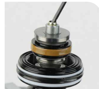
Conjunto del pistón instalado
