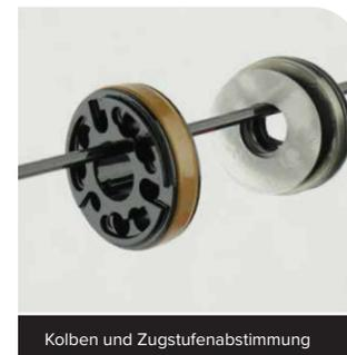
Kolben und Zugstufenabstimmung
