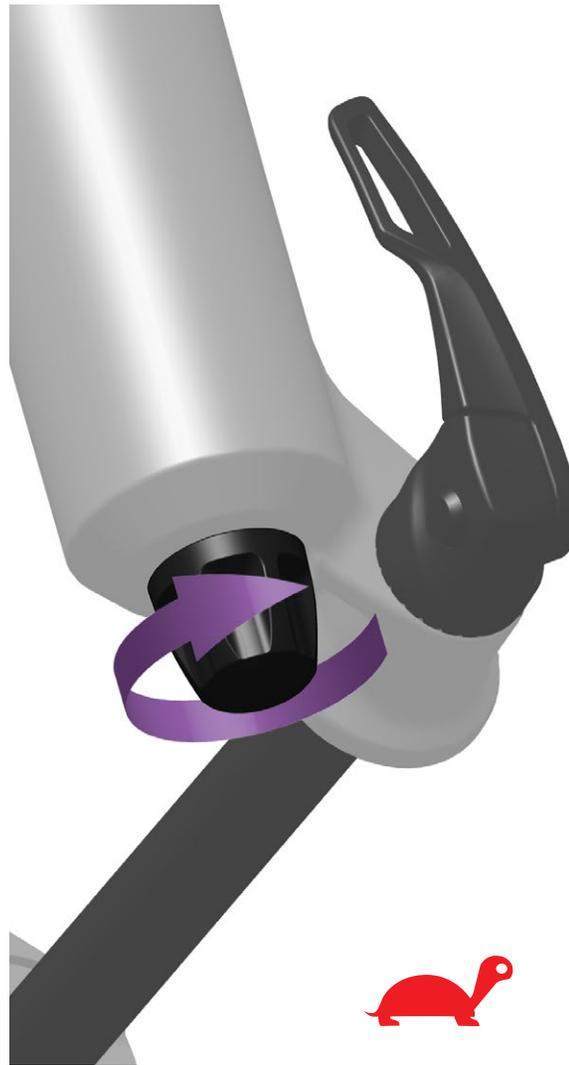
Pour **réduire** la vitesse de la détente (retour plus lent), tournez la molette de réglage de la détente dans le **sens des aiguilles d'une montre**.
