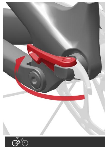
Feche a alavanca e confirme que ela não toca no garfo nem no quadro. A tensão na alavanca será suficiente se a alavanca deixar uma marca impressa na sua mão.
