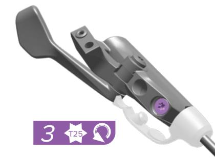
**Commande à distance 1x :** retirez le soufflet et retournez-le. Tournez la vis du régulateur Speed dans le sens inverse des aiguilles d'une montre, jusqu'à ce qu'elle se bloque. Remettez le soufflet en place.
