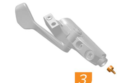
**1x Remote:** Retire a capa flexível do tubo flexível.
