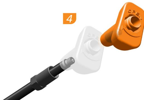
Drej T-værktøjet med uret, indtil slangespidsen går løs fra hydraulikslangen. Slangespidsen vil blive inde i T-værktøjet, når det er fjernet.
