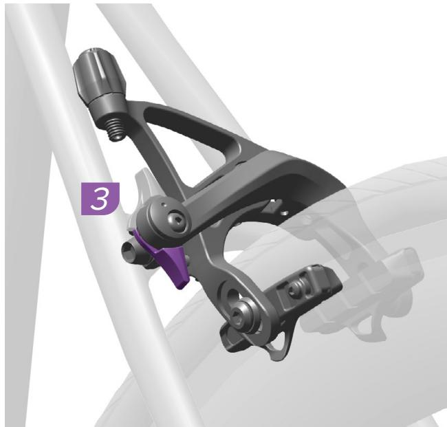
Montați etrierul pe cadru sau pe furcă. Centrați etrierul pe jantă și strângeti piulița de fixare atât cât este necesar pentru ca poziția etrierului să poată fi ajustată cu ușurință.
