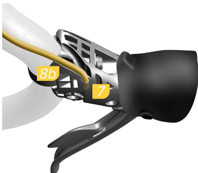
Sæt yder-gearkablet ind i kraven på 4 mm monteret fra fabrikken. Før yderkablet foran (8a) eller bag styret (8b) med hjælp af føringskanalerne på gearskifteren.
