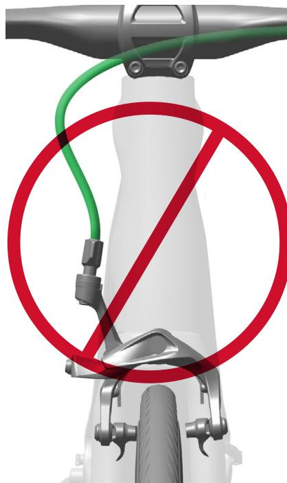
Sørg for, at yderkablet er skåret af til den rette længde. Hvis yderkablet er for langt, vil det skubbe kalibren væk fra en centreret position. Hvis yderkablet er for kort, vil det trække kalibren væk fra en centreret position.
