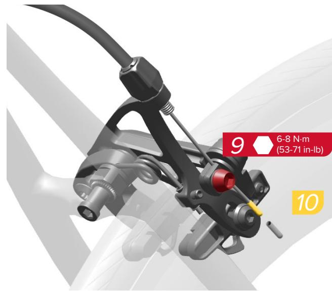
Monter en krave på 5 mm på yderkablet, og monter kablet og yderkablet på kalibrens kabeljustering. Træk kablet gennem rillen på kabelklemmeskiven.
