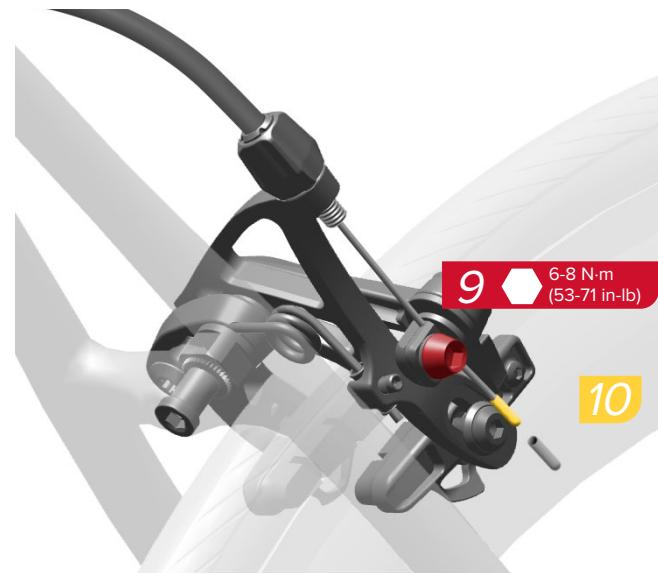
Installez une virole de 5 mm sur la gaine, puis insérez le câble et sa gaine dans le bariillet de réglage de l'étrier. Vissez le câble dans l'encoche de la rondelle du serre-câble.
