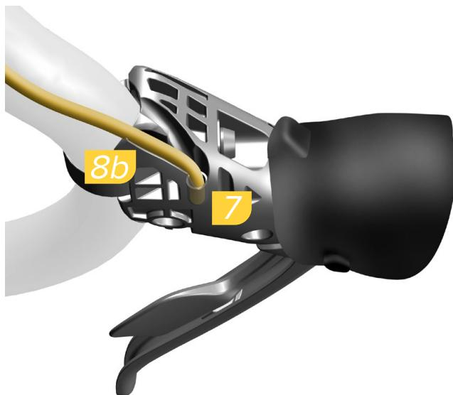
Insérez la gaine de la manette de dérailleur dans la virole de 4 mm montée en usine. Faites passer la gaine par l'avant (8a) ou par l'arrière du cintre (8b) à l'aide des encoches de la manette de dérailleur prévues pour le passage du câble.
