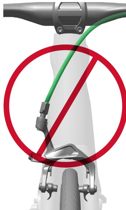
Assegure-se de que a bainha foi cortada ao comprimento apropriado. Se o comprimento da bainha for demasiado comprido, ela irá empurrar a maxila para fora duma posição central. Se o comprimento da bainha for demasiado curto, ela irá puxar a maxila para fora duma posição central.
