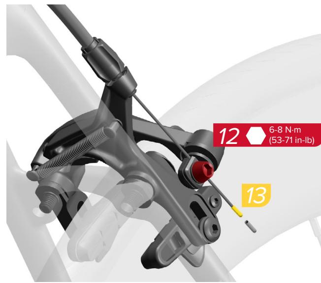
Installez une virole de 5 mm sur la gaine, puis insérez le câble et sa gaine dans le barillet de réglage de l'étrier. Vissez le câble dans l'encoche de la rondelle du serre-câble.
