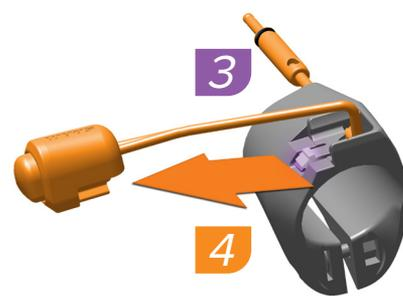
**Para MultiClics com ClampClics:** Retire o travão conforme as instruções do fabricante do travão. Use uma chave sextavada de 2 mm para afrouxar o perno da braçadeira e retire o ClampClic.
