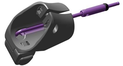
Instale o fio eléctrico MultiClic dentro do orificio do ClampClic. Instale o MultiClic no suporte de montagem do ClampClic até que ele encaixe bem no seu lugar. Instale o fio eléctrico MultiClic para dentro do entalhe que está do lado de dentro da braçadeira.
