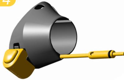
Insérez le fil du MultiClic dans l'orifice du ClampClic. Installez le MultiClic sur le support ClampClic jusqu'à ce qu'il s'enclenche dans son emplacement. Insérez le fil du MultiClic dans la rainure située à l'intérieur du support.
