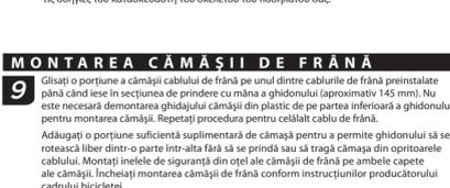
Préciser le montage de la câbles de frein. Pour le montage de la câbles de frein, insérez la longueur de câble de frein dans une des ouvertures de montage des câbles de frein déjà installées sur le guidon. Lorsque vous avez trouvé la position souhaitée, serrez le câble de frein sur le guidon. Répétez ces opérations pour l'autre câble de frein.
