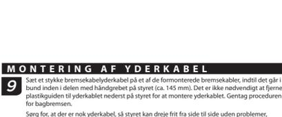
Set et styklike bremskabelvedrækabel på et af de formonterede bremskabler, indtil det går i bund inden i den anden side af forlængeren. Når du har fundet den ønskede position, skal du fjerne pålægsbolten til yderkabel neders på styret for at montere yderkabet. Gentag proceduren for bagbremsen.
