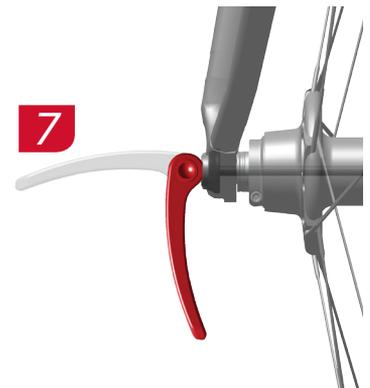
Pentru a crește tensiunea manetei deschideți-o și rotiți piulița de reglare spre dreapta cu mâna. Închideți maneta pentru a verifica tensiunea. Tensiunea manetei este suficientă dacă nu poate fi rotită când este închisă. Dacă maneta poate fi rotită când este închisă, tensiunea este insuficientă și trebuie mărită.
